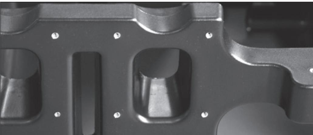
Detail einer 1800 mm hohen komplex geformten Einheit für die Aufnahme von Komponenten einer Wasseraufbereitungsanlage. Über die eingesinterten Muttern werden die Teile direkt befestigt. Die Anlage kommt mit Feuchtigkeit und Chemikalien in Kontakt. Die Geräteinheit ist chemikalienbeständig und korrodiert nicht.
