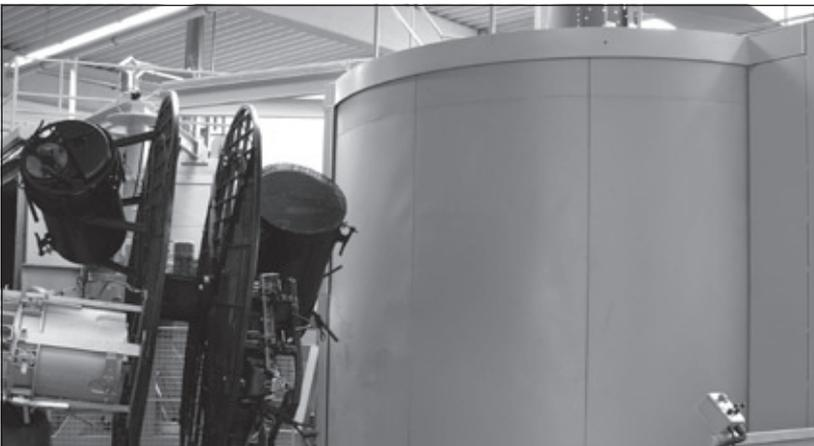
Die maximalen Abmessungen der Produkte entsprechen dem maximalen Volumen der Anlagen-Schmelzkammer. Der kontrolliert gesteuerte Schmelzvorgang erfolgt drucklos unter gleichmäßiger Rotation der Werkzeuge. Er wird jeweils auf die Produktart abgestimmt. Ebenso erfolgt der Abkühlvorgang in der Produktionsanlage kontrolliert.
